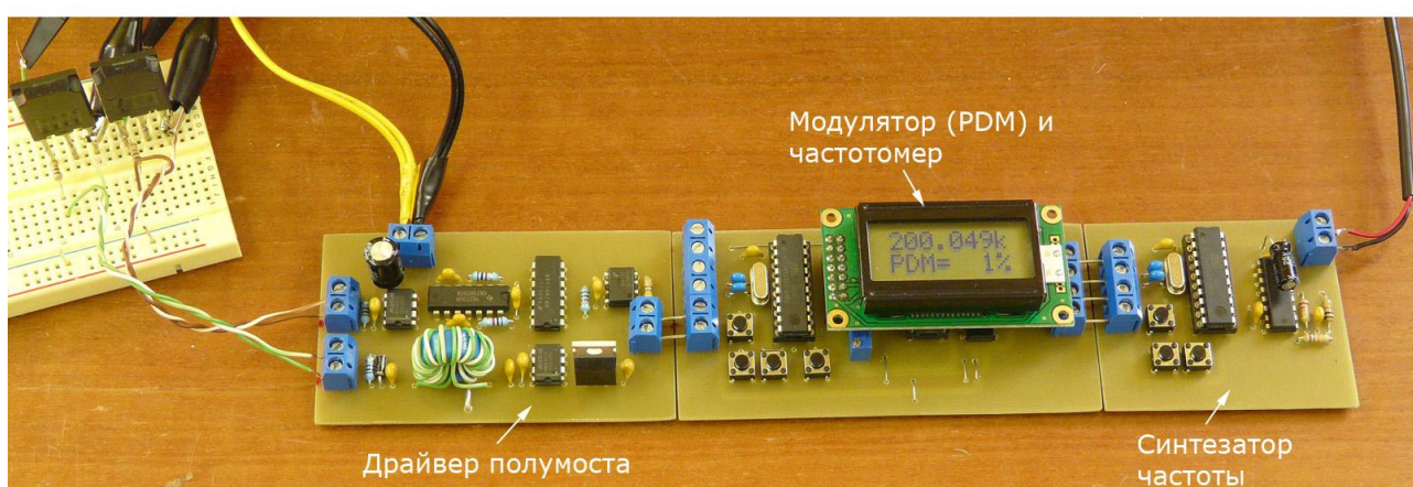
Рис.4. Блок-схема и внешний вид макета для испытания драйвера
