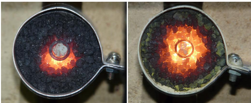
Рис.10. Варианты работы печи с небольшим отношением диаметров электродов ( D/d \sim 4 )
